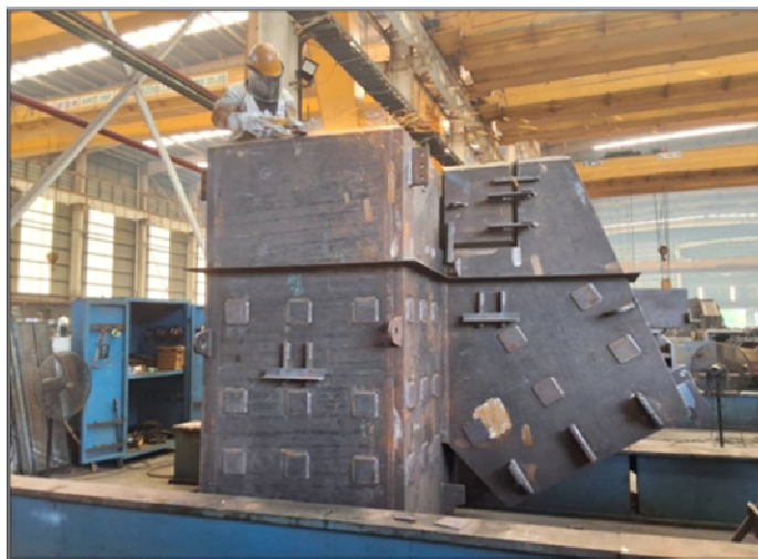
รูปตัวอย่างงานเสา (Column-Box)
